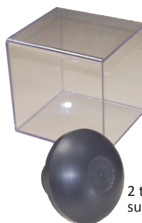
réceptacle amovible de récupération en cas d'éclatement du tube en test
